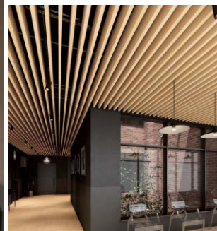
天井材：グラビオルバーUSボルト固定式(US12(ヒノキ)) 高さ150mm×幅30mm、施工100mmピッチ
